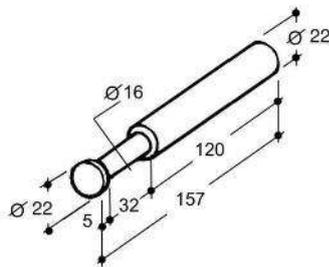
**Art. 30-01273**Perno disassato per testata ribaltabile Ø 22-Ø 16 testa Ø 22 L=157
