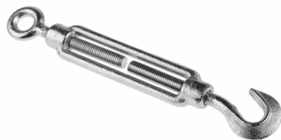
Art. 34-00054 Tenditore zincato a 1 occhio + 1 gancio (5/16) - fune D.8 Galvanized 1 eye + 1 hook turnbuckle (5/16) - rope D.8 (Kg.0,400)
